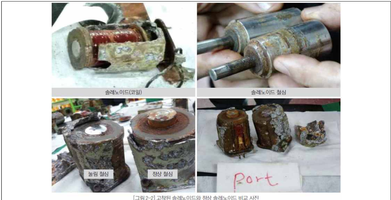
[사진 5] 세월호 솔레노이드 밸브의 철심 고착 사진(선조위 보고서)
