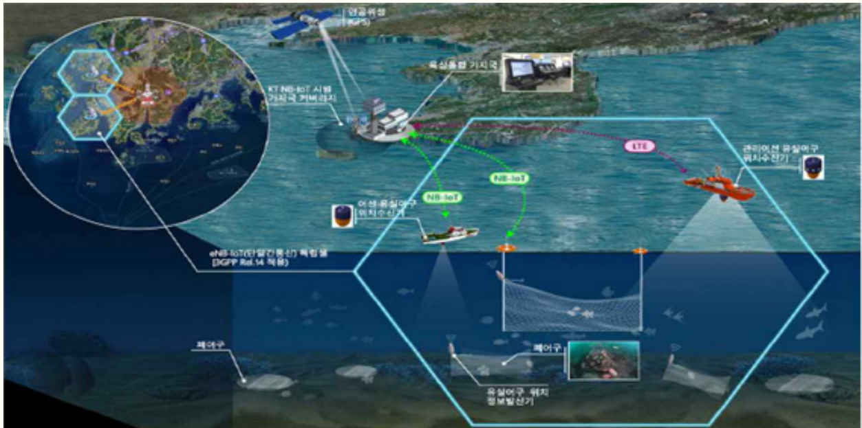
[그림 2] 어구 자동식별 통합 모니터링 시스템
