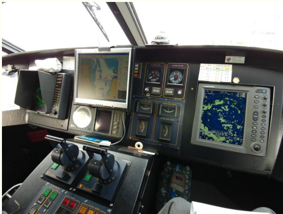
[사진 1] 선장 의자에 앉아 본 조타실 전면 항해 장비 (AIS플로터, 레이더)
