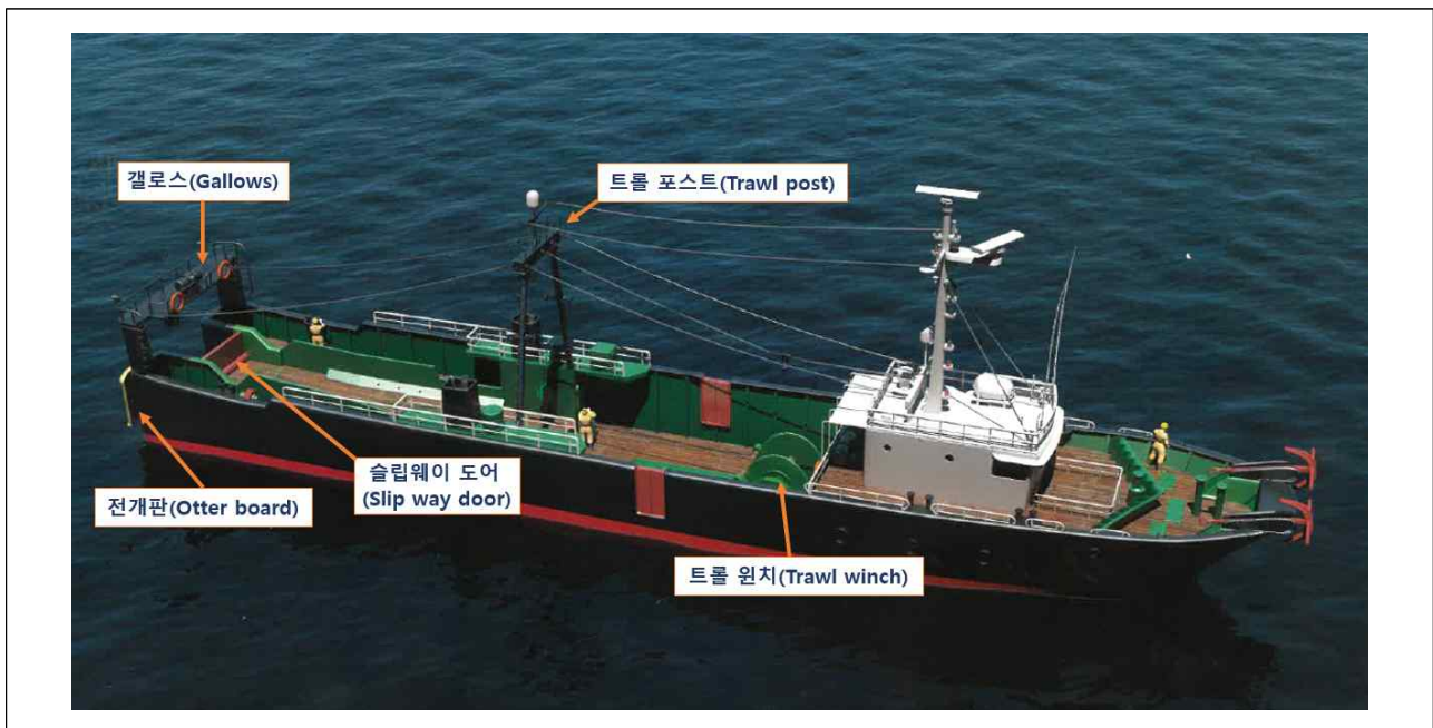
<그림 2> 대형트롤어선의 주요 조업장비(국립수산물과학원 자료 활용)
