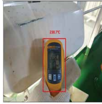
ILLUMINATION (SODIUM) LIGHT 소제 이후, 온도 측정값 (평균)
