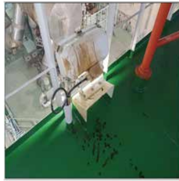
E/R ILLUMINATION (SODIUM) LIGHT 오염부
