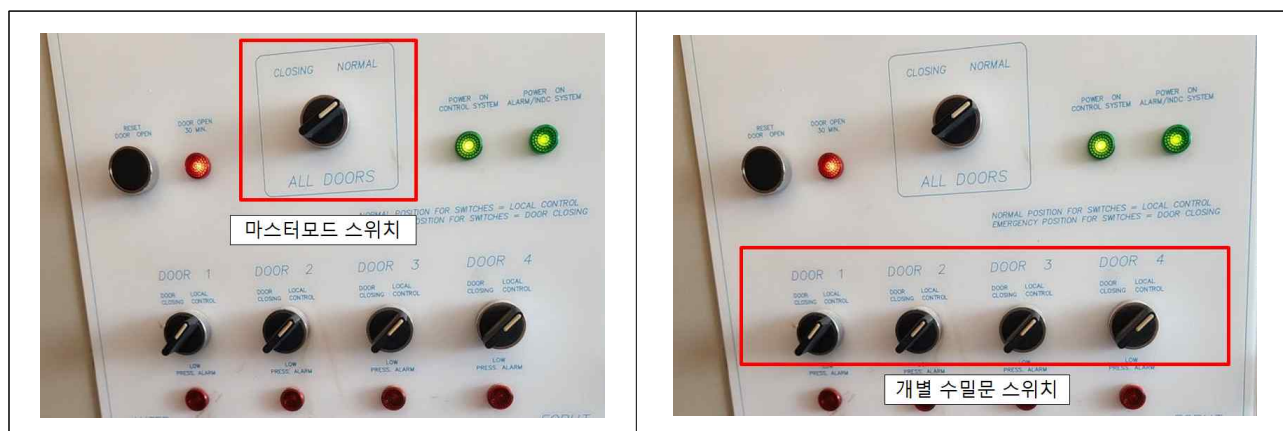
<그림 18> 다른 시험조사선 “온누리호”에 설치된 수밀문 제어반
