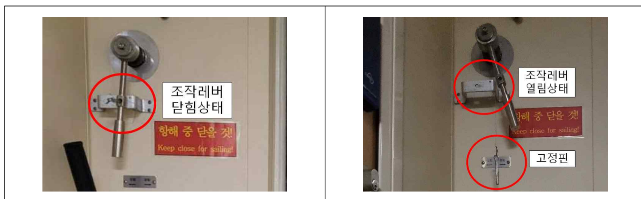
<그림 14> 5번 수밀문 복도쪽 조작레버 닫힘상태(좌)·열림상태(우)
