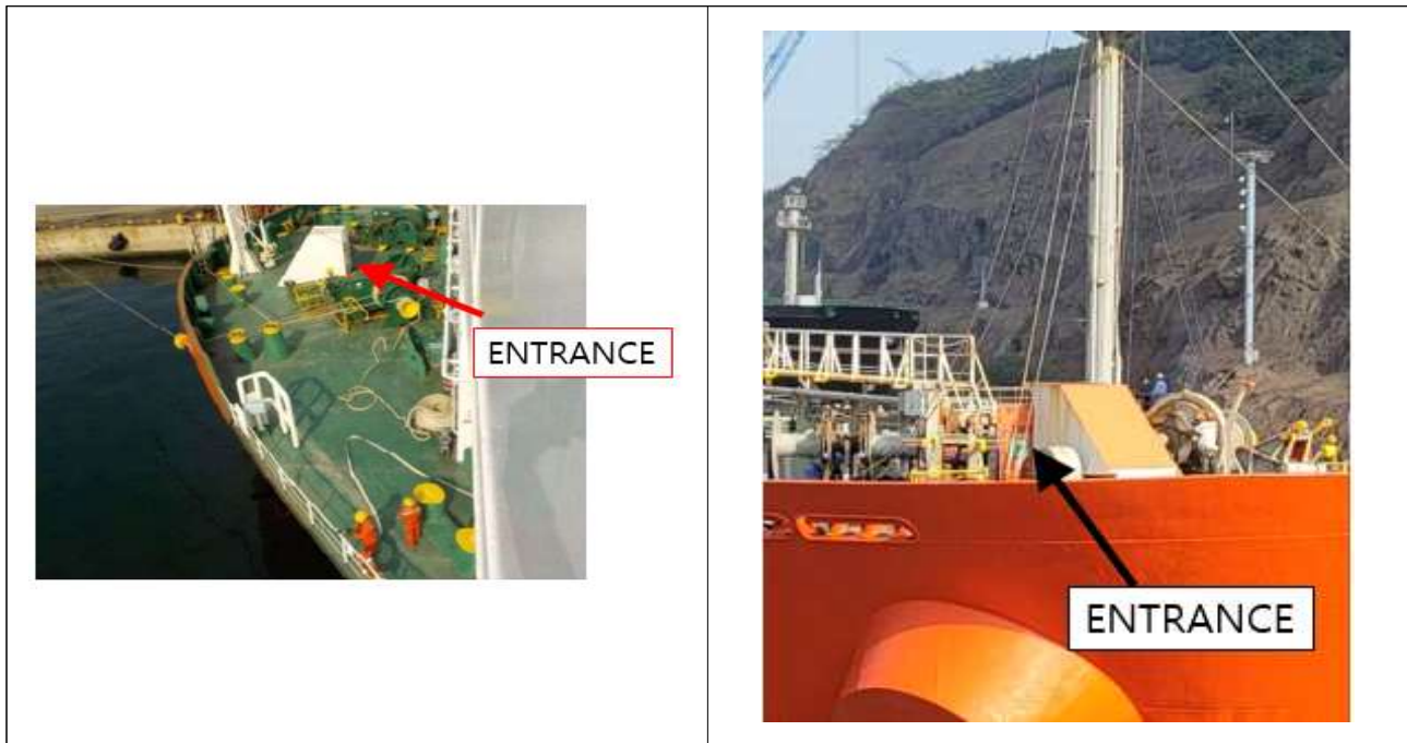
<그림 15> 앞뒤로 여닫는 방식의 출입구(예시)
