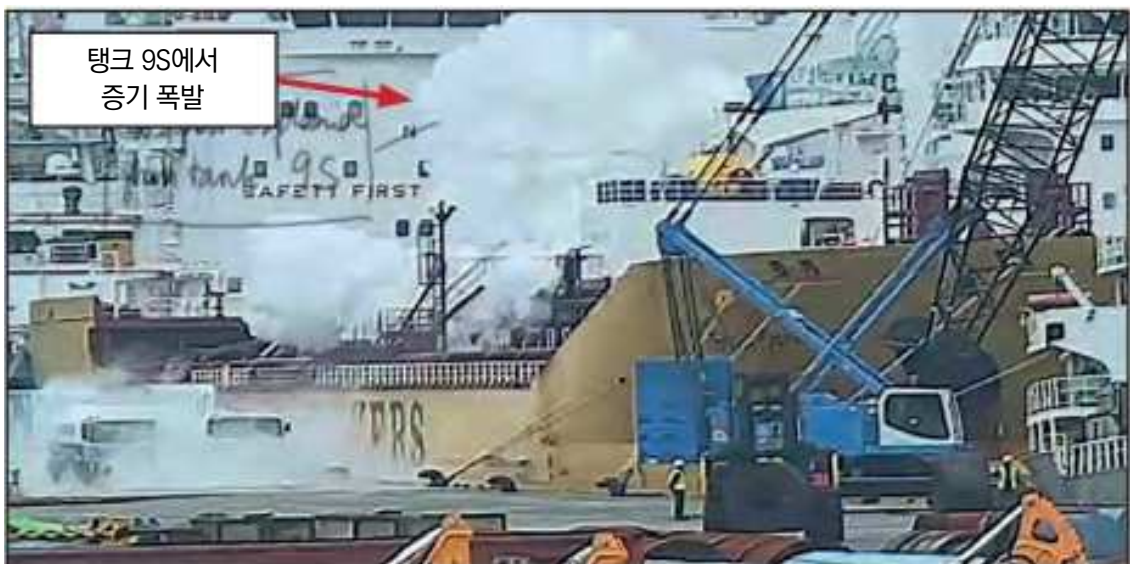
그림 4: 탱크 파열과 증기배출 장면(CCTV 정지화면)
