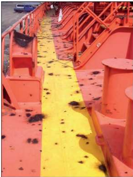
그림 7: 바우 달리안호 상갑판 위 연소된 스티렌 모노머 잔여물
