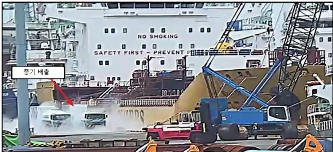
그림 3: 9S의 P/V 밸브에서 여전히 배출되고 있는 증기(CCTV 정지화면)
