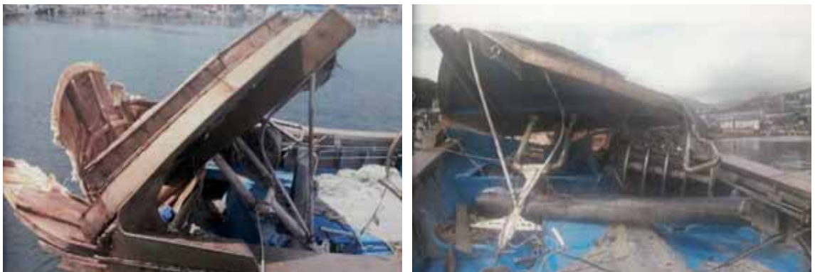
[그림 1] D호 선수부 손상 상태
