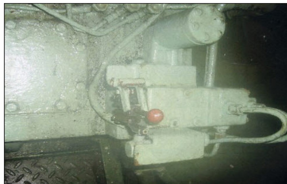
<그림 56. 클러치 레버에 스토퍼가 채워진 상태>
