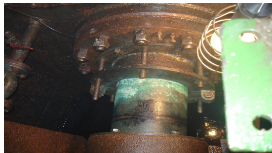
[사진2, 선미관 글랜드패킹을 채우는 상태]
