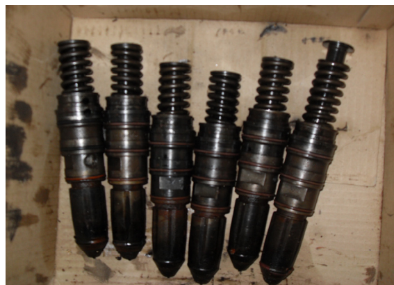
[사진 2 손상된 인젝터와 정상 인젝터의 모습]
