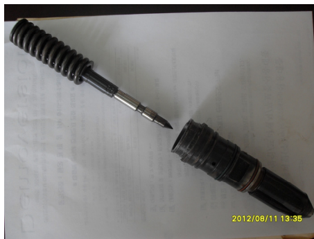
[사진 8 연료인젝터의 분해된 모습]
