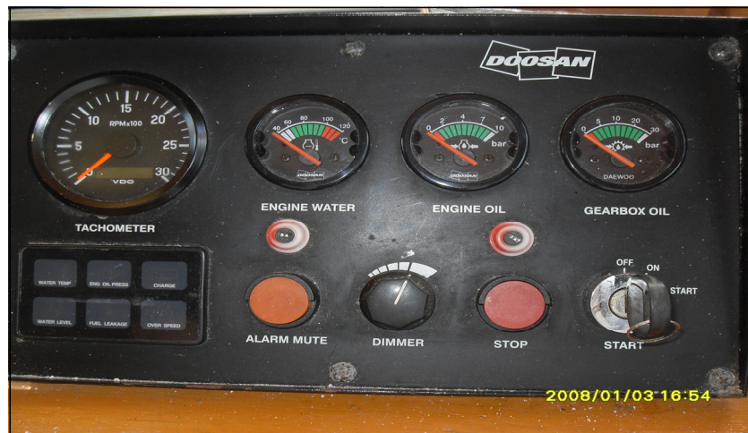
[사진 3. 조타실에 설치된 주기관 계기반의 각 게이지와 경보장치]
