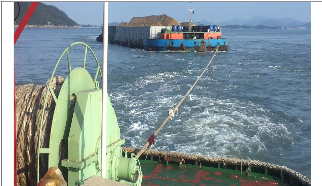
[사진 1] 예인선 77신정호가 부선 세아호를 예인 당시 부선의 휘둘림 현상
