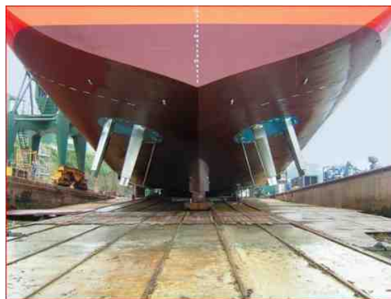
[그림 1] 같은 종류 선박에 보이스 슈나يدر 프로펠러가 설치된 모습
