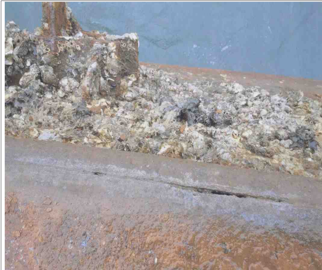
[사진 3] 전복된 우현 선미부 선저 균열·파공 상태(사고 후 인양 전 임시로 용접하기 위하여 녹을 제거한 상태)
