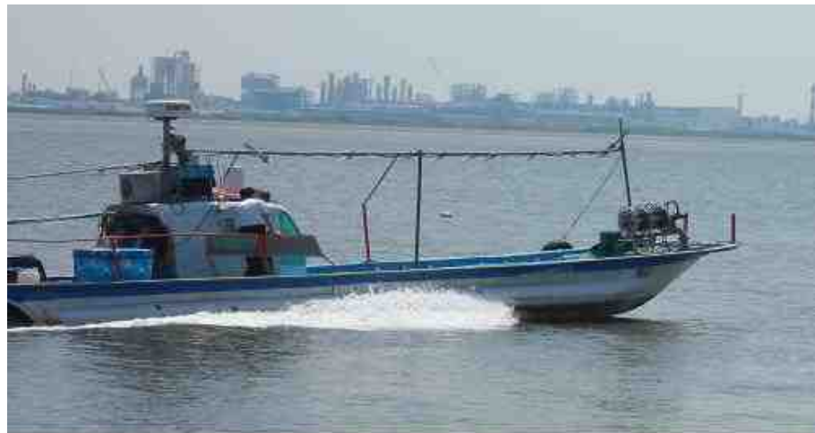
[사진 1] 재림호의 속력 약 17노트(rpm 3500) 항해 상태(선수부 약 50cm 부상)
