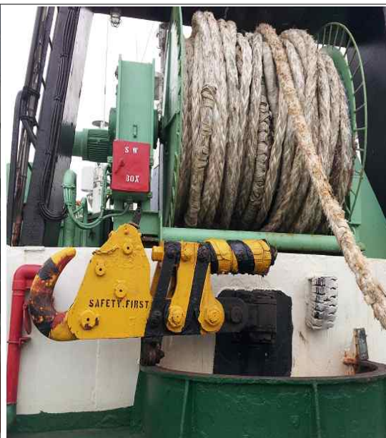
<사진. 6> 예인줄 드럼 및 Hook(180° 회전)
