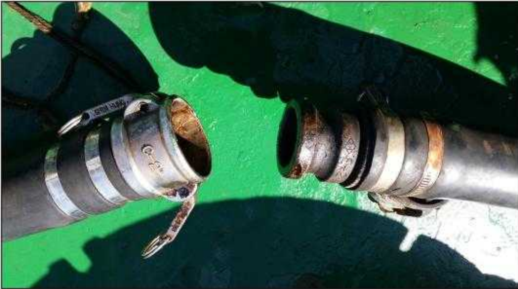
[사진 3] 이송호스 연결부 커플러(C형)와 어댑터(E형)의 분리된 상태
