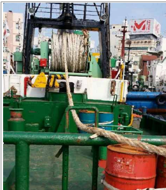
<사진. 5> 예인줄 가이드를 통과해 드럼에 연결한 상태
