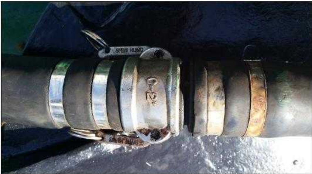
[사진 4] 이송호스 연결부의 결합된 상태
