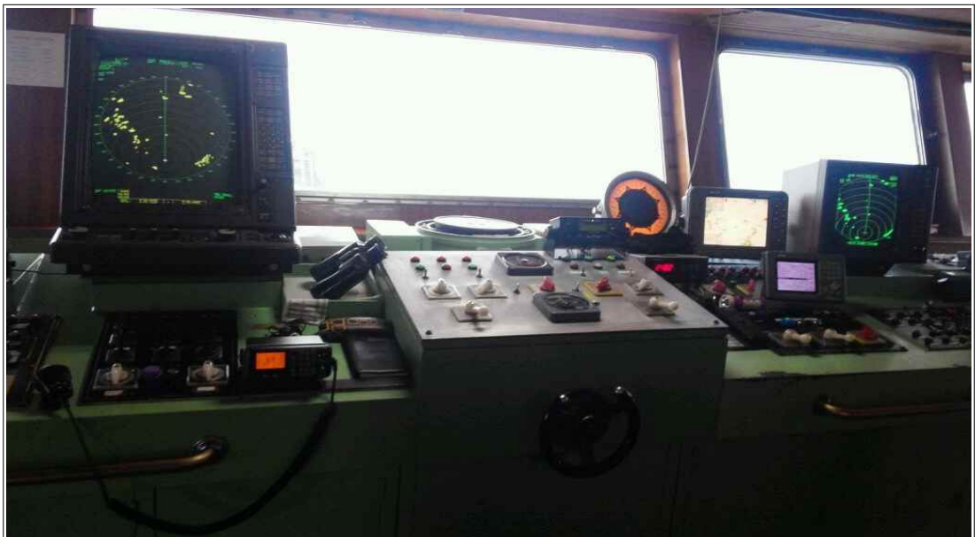
[그림 1] 영동호 조타실의 전면에 주요 항해장비 배치형태
