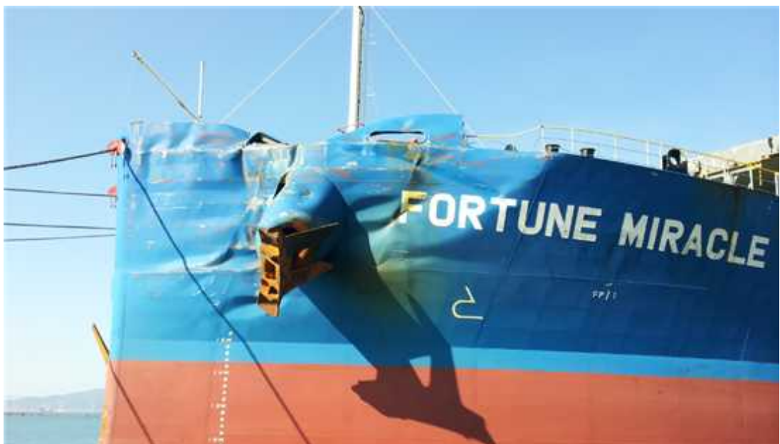
그림 8. 포춘미라클 손상부위 사진
