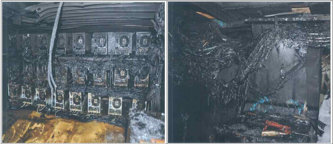
<그림 2> 안정기와 배전선의 소손 된 모습
