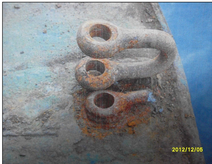
[그림 1] 준설선 와이케이티-2호 선미 상갑판에 설치한 임시 계선주와 재현모습
