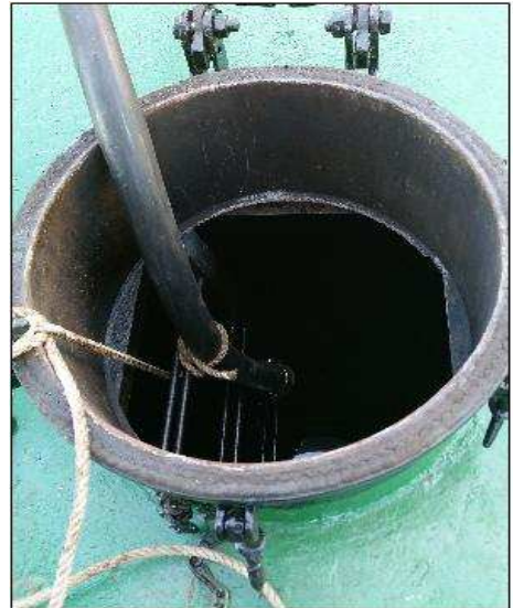
[사진 2] 폐기물 이송호스 끝단의 화물창내 고정된 상태
