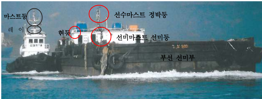
그림 1. 강남티-3호 및 강남5001호 선체 전경(공선상태인 부선의 등화 모습)
