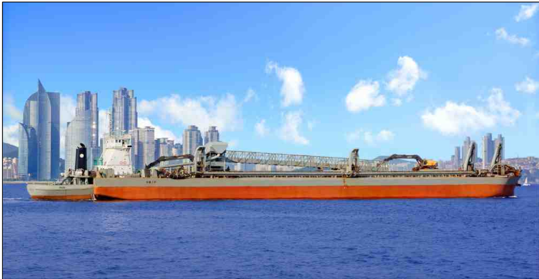
[사진 1] 압항예인선 대홍8호와 부산 대홍7호가 연결된 모습
