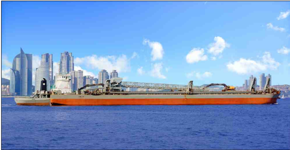
[사진 1] 압항예인선 대홍8호와 부선 대홍7호가 연결된 모습
