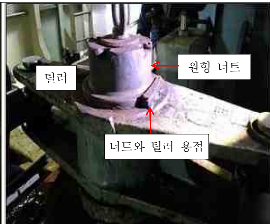
[사진 2] 사고 후 재조립된 좌현 타의 원형 너트(풀림방지를 위해 용접)
