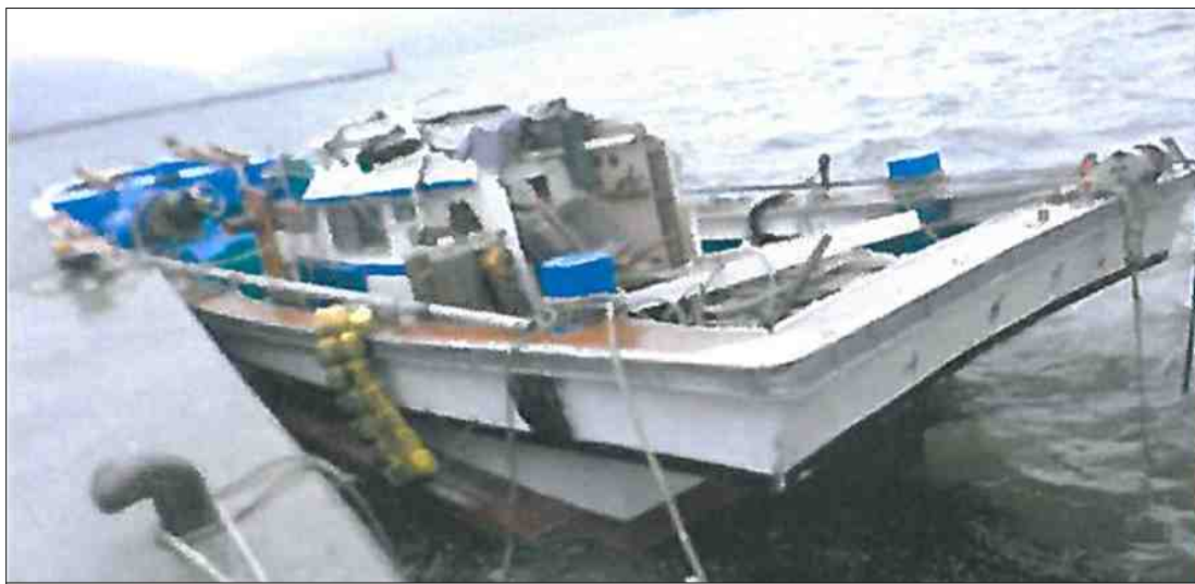
[그림 3] 청명호 충돌 후 모습(조타실 상부 등 손상)
