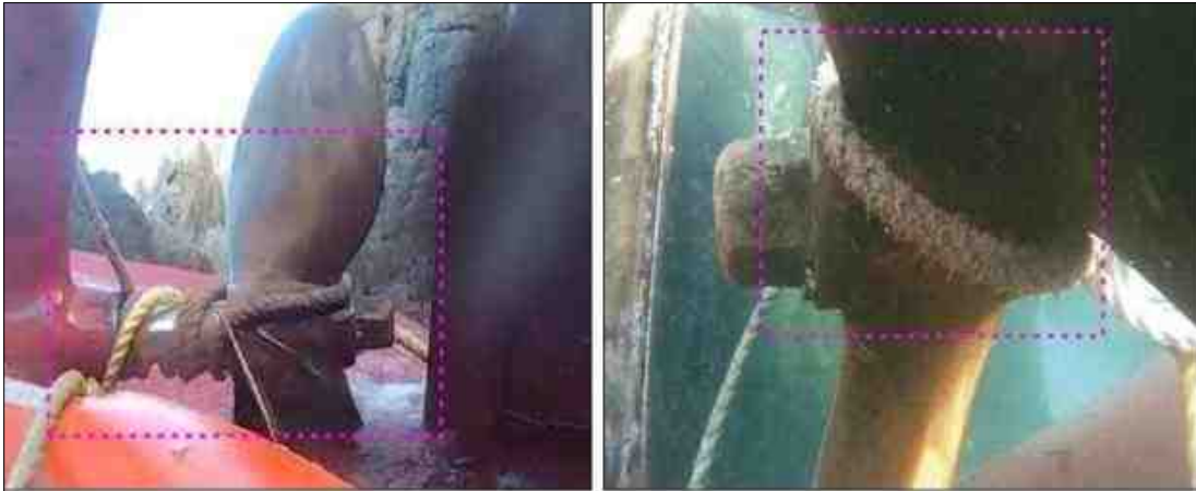
[그림 4] 추진기 및 추진축에 감겨 있는 진회색 로프
