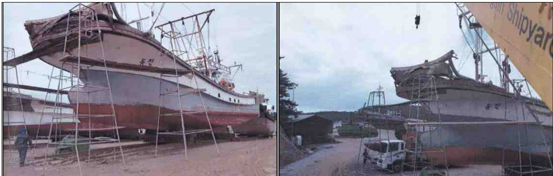
[사진 1] 어선 동진호의 정선수 손상부 모습
