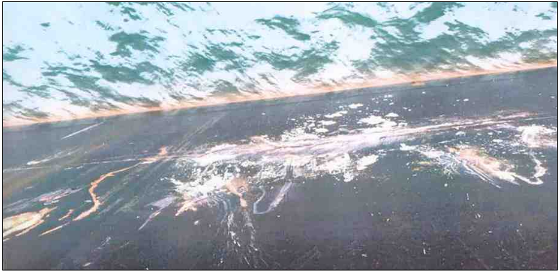
[사진 2] 산적화물선 에프 스타호의 좌현 선체외판 손상부 모습
