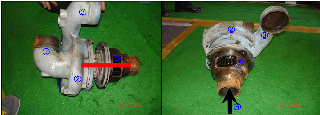
[그림 2] 해수펌프 각부 작용명칭 ①해수 흡입 ②임펠러(내부) ③해수 배출 ④회전축(내부) ⑤주기관 연결기어 ⑥윤활유펌프 연결
