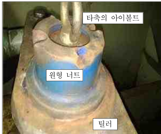
[사진 1] 건조당시 설치된 우현 타의 원형 너트(풀림방지용 스플리트 핀 없음)
