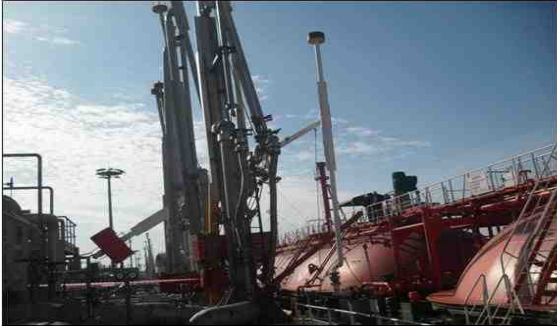
[사진 3] 육상 로딩암과 선체 중앙부의 매니폴드 연결 모습
