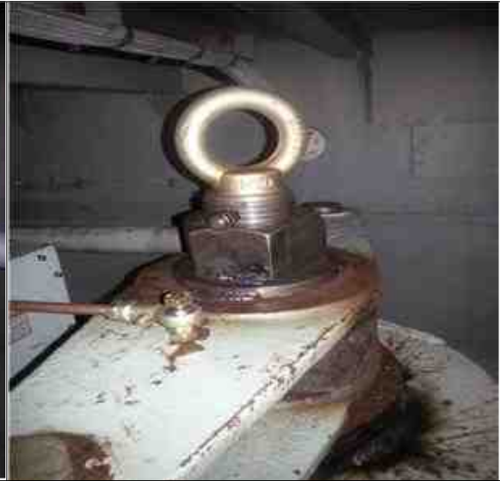
[사진 2] 사고 후 우현 타축의 타두재 상단에 육각형 너트와 스플리트 키를 설치함
