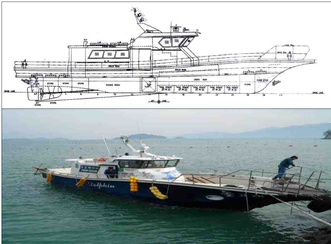
[그림 1] 돌고래호 일반배치도 및 계류 모습
