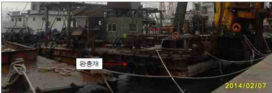
[사진 4] 신양101호 우현선수 완충재가 부착된 모습(촬영일시: ' 14. 2. 7, 08:44)
