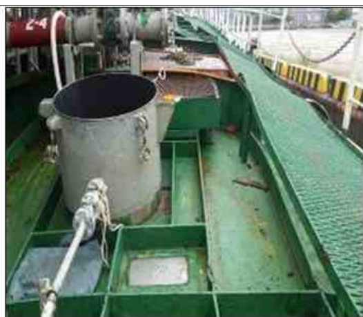
[그림 5] 화물창이 부풀어 올라와 있는 모습
