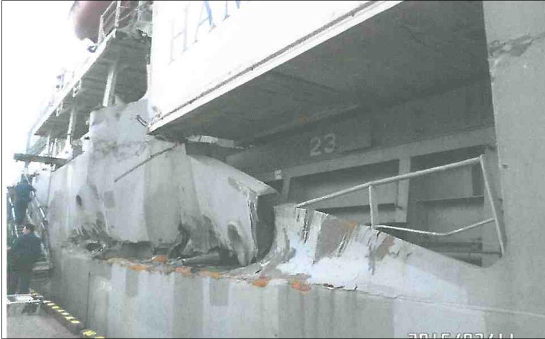
[사진 2] 페가서스 페이스호 손상부(우현 선미쪽 불워크)
