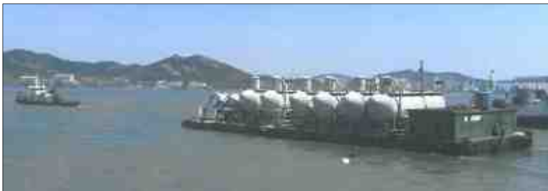
[그림 1] 신양207호 상갑판에 설치된 시멘트탱크 8기 및 예인 모습
