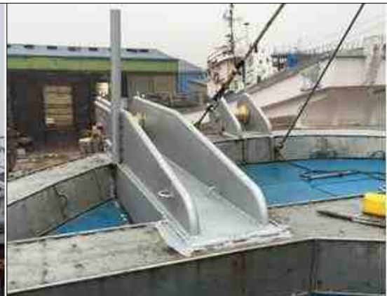
[사진 2] 제5대경호의 선수 닻 받침대 및 양망기 롤러가이드 수리완료
