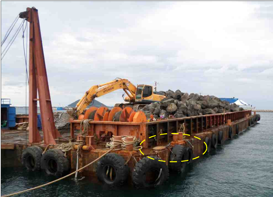
[사진 1] 삼창5000호 사석 선적 중(8.18. 16:27) 우현선미 부력탱크 맨홀에 파란색 배수 파이프 설치 모습(노란 점선 내)
