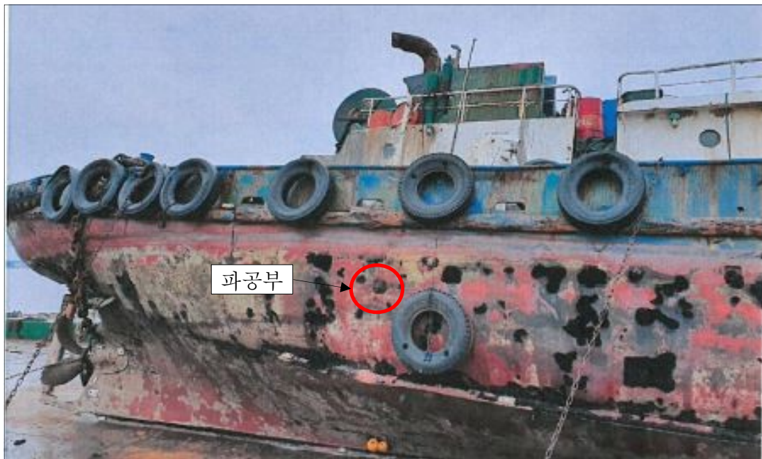
[사진 3] 제305해송호 우현 외판에 충돌로 발생한 파공부 모습
