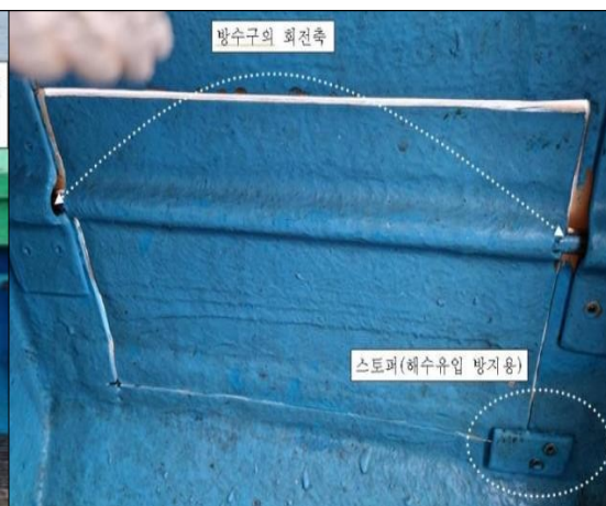
[그림 4] 방수구의 내측 모습 (수평 힌지식 플랩도어(Flap Door))
