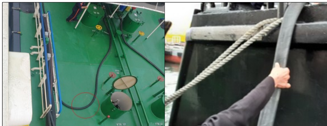
[사진 7] 동양1호 급유호스 상태 비교(왼쪽 : 급유 중 / 오른쪽 급유 후)
