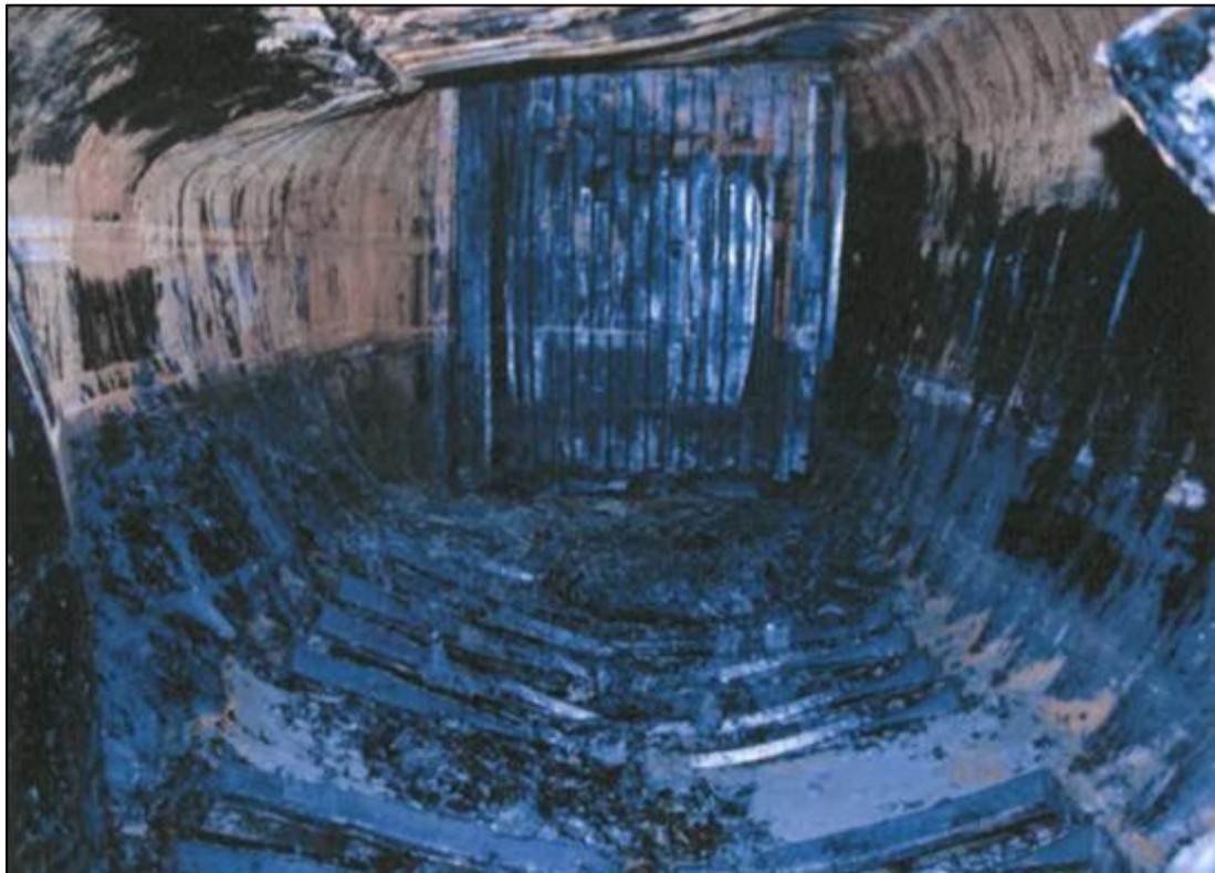
[사진 9] KMTU7410828 폭발압력으로 팽창된 내부
