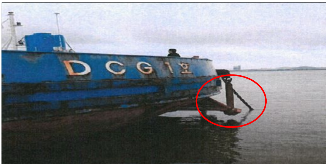
[사진 1] 디씨지1호 선수에 돌출된 형태로 설치되어 있는 닻 모습
