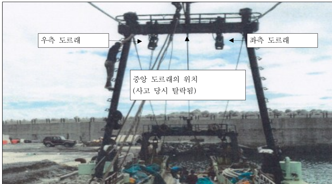
[사진 1] 트롤 포스트 가로 보에 설치된 도르래(선미 방향으로 바라본 모습)
