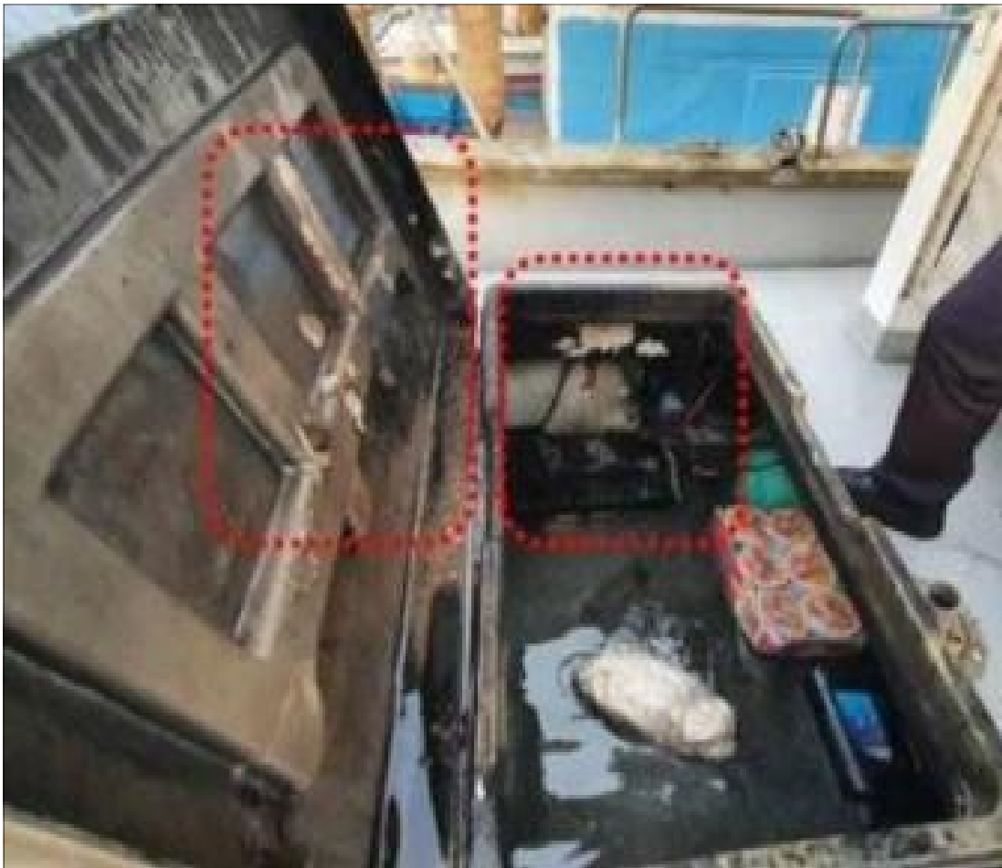
[사진 5] 1차 화재 진압 후 축전지실 상부 덮개 및 축전지 손상 모습
