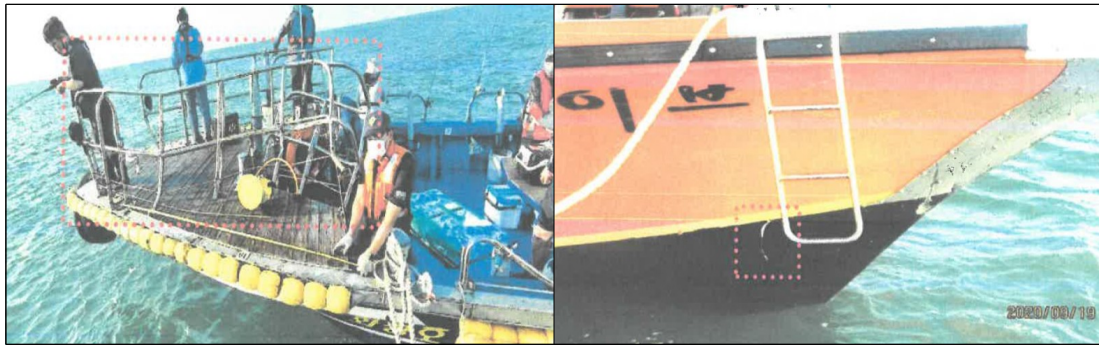
[그림 5] 화성호 좌현 안전펜스 파손부위(좌) 및 뉴웨이브호 우현 충돌흔(우) 사진
